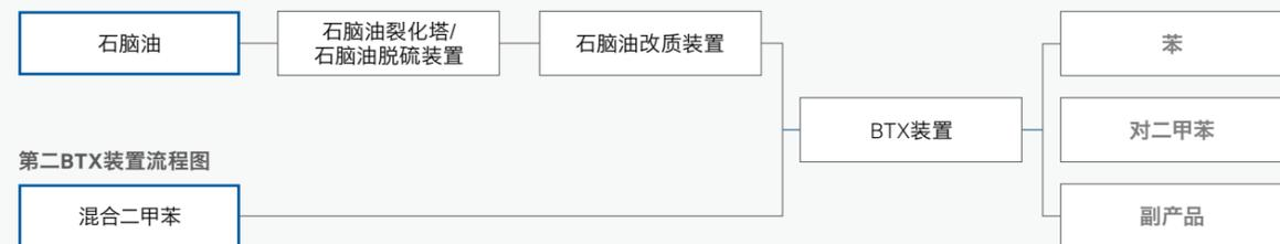
第二BTX装置流程图
